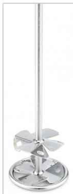
Два диска с вращающимися в противоположном направлении лопастями создают динамичный поток в емкости для смешивания. Лопастями на дисках разнонаправлено воздействуют на смесь, попеременно перемещая ее то вверх, то вниз. Краски, дисперсии, клеевые составы, клей, заливочные массы.
