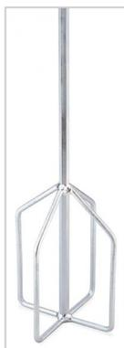
Имеющие круглое сечение лопасти мешалки предотвращают попадание в смесь пузырьков воздуха. Идеальны для всех материалов, при работе с которыми необходимо избегать попадания воздуха в смесь: выравнивающие массы, шпатлевки, клей, уплотнительные составы.
