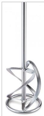
Три правосторонние спирали "ввинчиваются" в материал. Это позволяет быстро и интенсивно размешивать даже тяжелые и вязкие смеси. Используется для замешивания растворов и тяжелых смесей. Идеально подходит для: строительных растворов, бетона, штукатурки, стяжки, монтажного клея, толстослойных покрытий.
