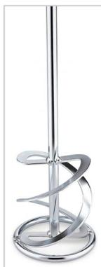
Две правосторонние спирали для замеса и размешивания вязких и пастообразных материалов. Мешалка винтовым движением перемещается вниз и выдавливает смесь вверх. Широки диапазон применения: для плиточного клея, смесей для заделки швов, шпатлевок, готовой штукатурки, клеевых растворов, выравнивающих масс, стяжки.
