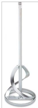
Два круговых элемента, расположенных в противоположном направлении относительно друг друга, давят смесь вниз, что позволяет избежать разбрызгивания жидкого материала. Идеальна для жидких и вязких материалов: красок, дисперсий, лаков, глазури, покрытий, клеевых составов, битума.
