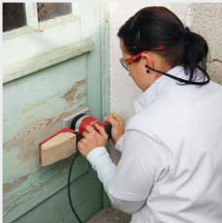
Die integrierte Staubabsaugung sorgt für mehr Sauberkeit am Arbeitsplatz und wirksamen Schutz für Ihre Gesundheit. Wahlweise mit Filterkassette oder mit Anschluss (Ø 27 mm) für Absauggeräte.
