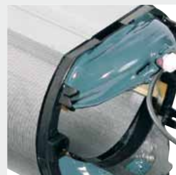
Epoxidbeschichtete Wicklung am Feldpaket.
