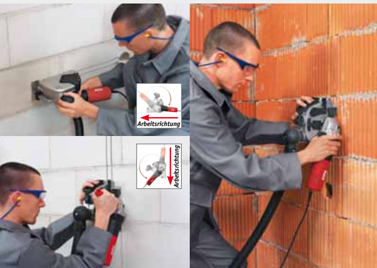
Kraftvoll in jeder Lage. Der Mauerschlitzer MS 1706 FR schlitzt bequem Nuten in Mauerwerk, Kalksandstein und Gasbeton. Sein patentierter, schwenkbarer Motor macht dabei schiebende horizontale sowie ziehende vertikale Schnitte möglich.
